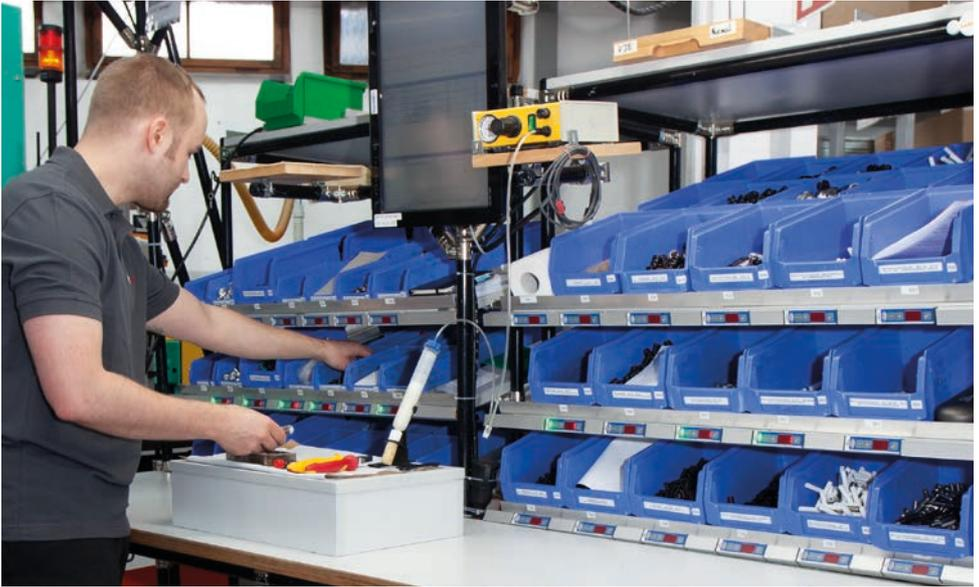
Bei der manuellen Montage in der Industrie ist es entscheidend, präzise, schnell und fehlerfrei zu arbeiten, um die Qualität und Sicherheit des Endproduktes zu gewährleisten und Termintreue sicherzustellen. Ein Pick-by-Light System von KBS kann hierbei effiziente Unterstützung bieten, um die Wettbewerbsfähigkeit zu sichern.
